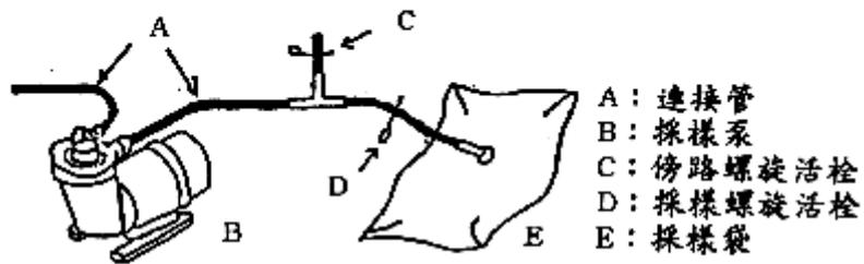
圖四 採樣袋直接採樣（周界及環境大氣）裝置之圖例
