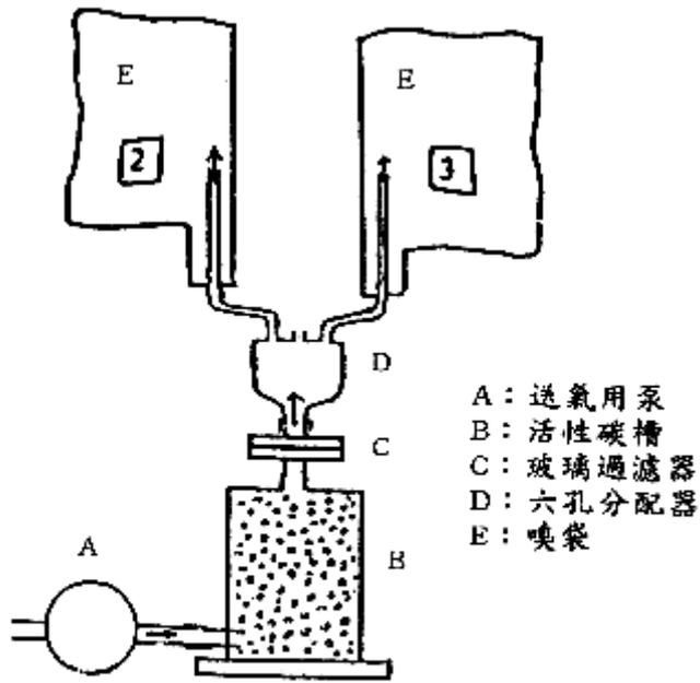
圖六 純淨空氣充填用裝置之圖例
