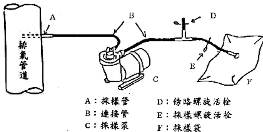
圖一 排放管道直接採樣裝置之圖例
