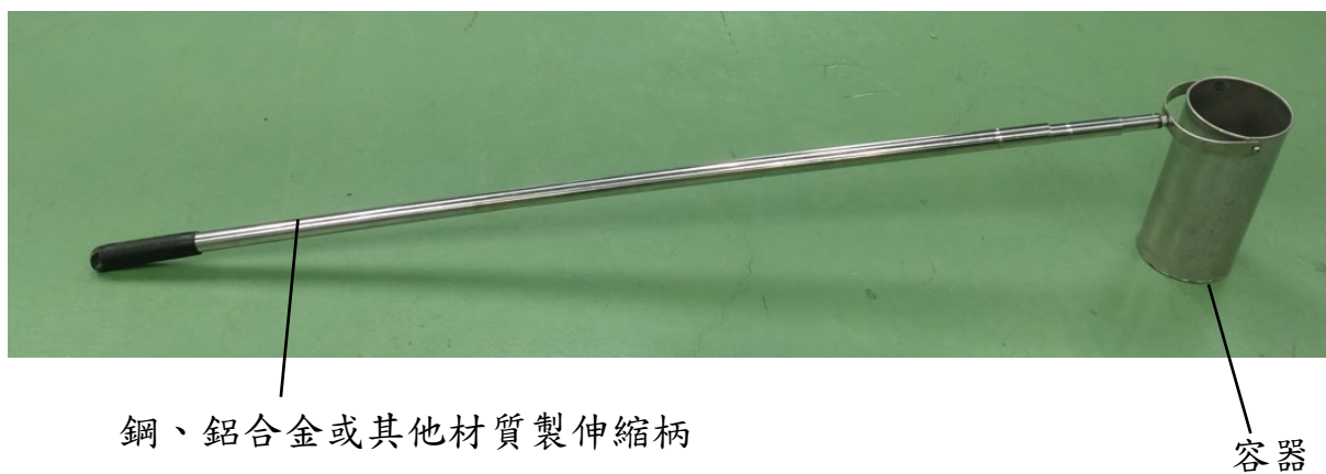
圖一 表層水採樣器
