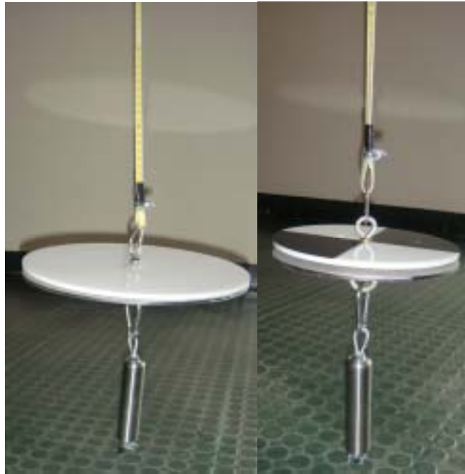
圖一 沙奇盤，左為白盤、右為黑白扇形相間，本身應有重量或附加重錘以使盤身可沈入水中，吊繩索具有標識之刻度。
