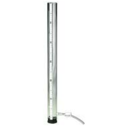
圖二 沙奇管，又稱透視度計。塑膠製之透明量桶，外部刻上刻度，內置一小型沙奇盤，底部有一排水閥。
