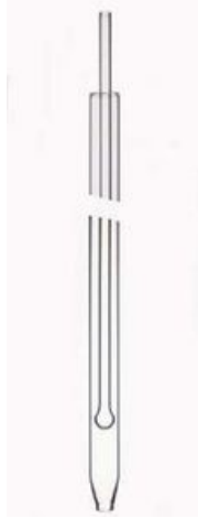
圖三 液體採樣管示意圖
