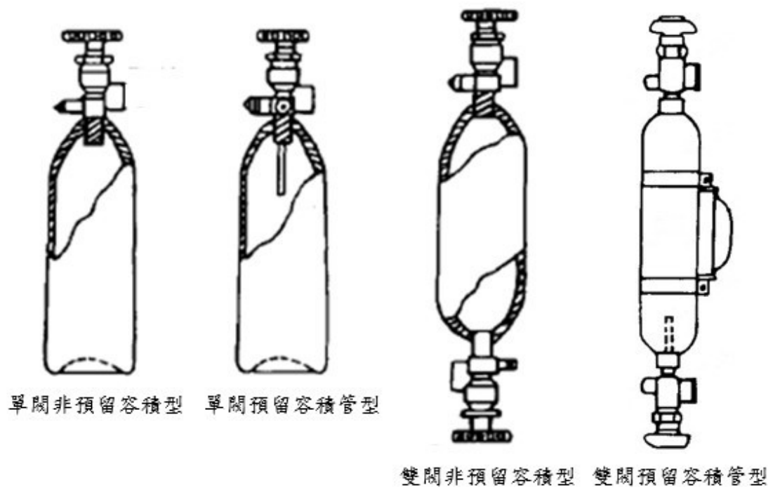
圖九 氣體鋼瓶示意圖
