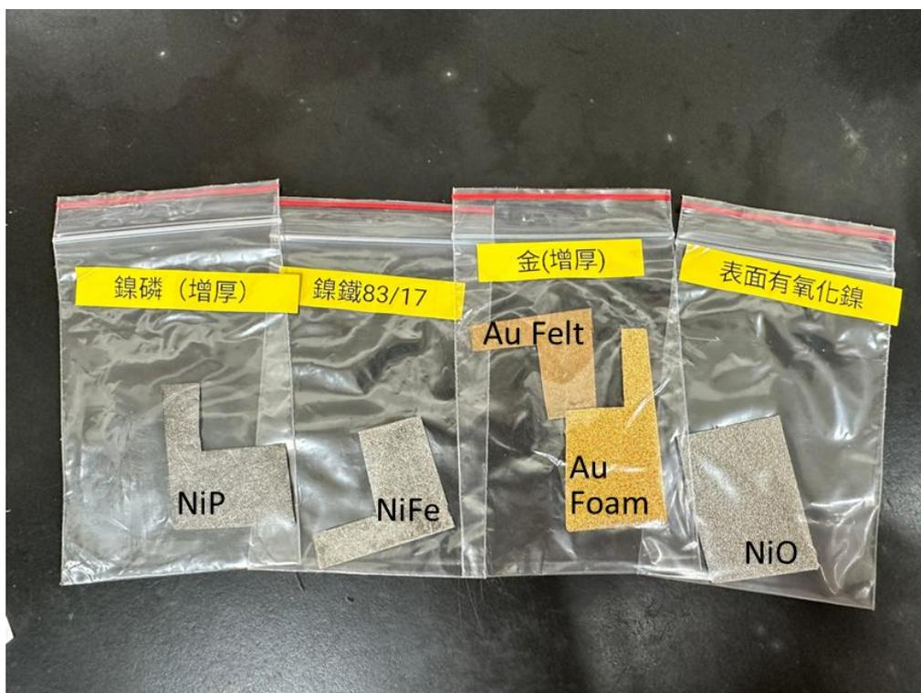
圖 51. 不同複合泡沫金屬催化陽極材料，依序為磷化鎳、鎳鐵、金氈、泡沫金
