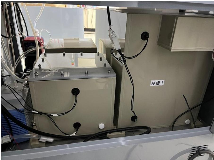
圖 66. 二氧化碳轉換設備電解液儲存槽背面(右)與電解液產物氣液分離槽(左)
