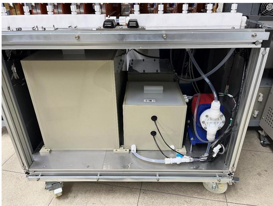
圖 65. 二氧化碳轉換設備電解液儲存槽正面(左)與電解液加熱槽(右)
