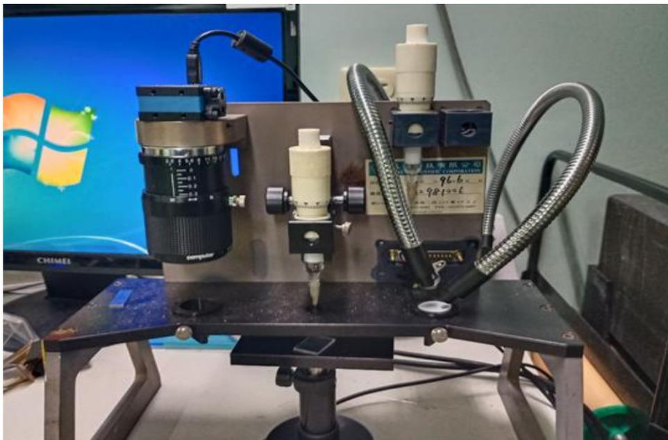
圖 28. 接觸角量測儀
