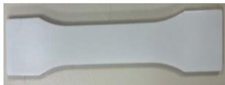
圖 4.1-29、N-12 再生紡用酯粒的混煉射出片
