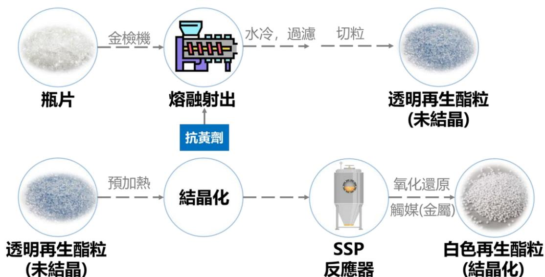
圖 4.1-13、瓶片至再生酯粒製造程序彙整示意
