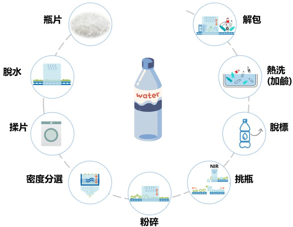
圖 4.1-12、PET 瓶磚至瓶片處理程序彙整示意
