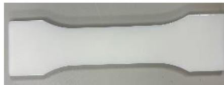
圖 4.1-25、N-08 原生紡用酯粒的混煉射出片
