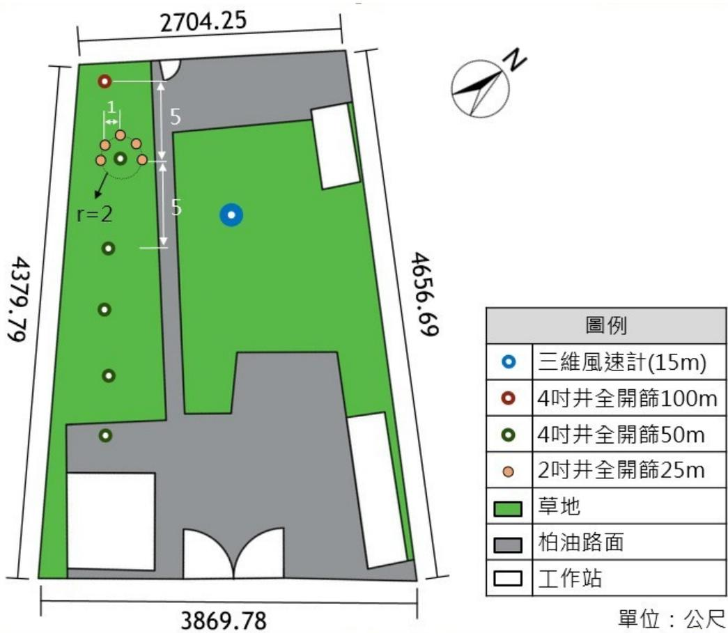
圖 2.3.29 TaiCOAST 臨海工作站的設施及地下水井配置圖 (林淇平博士提供)
