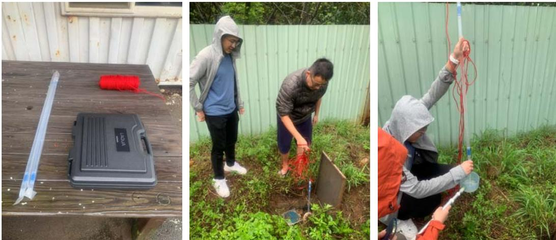
圖 2.3.32 左圖為採水所使用的貝勒管及分析儀器，中圖為使用貝勒管採水的過程，右圖將採到的水樣放入水瓢預備進行處理與分析。
