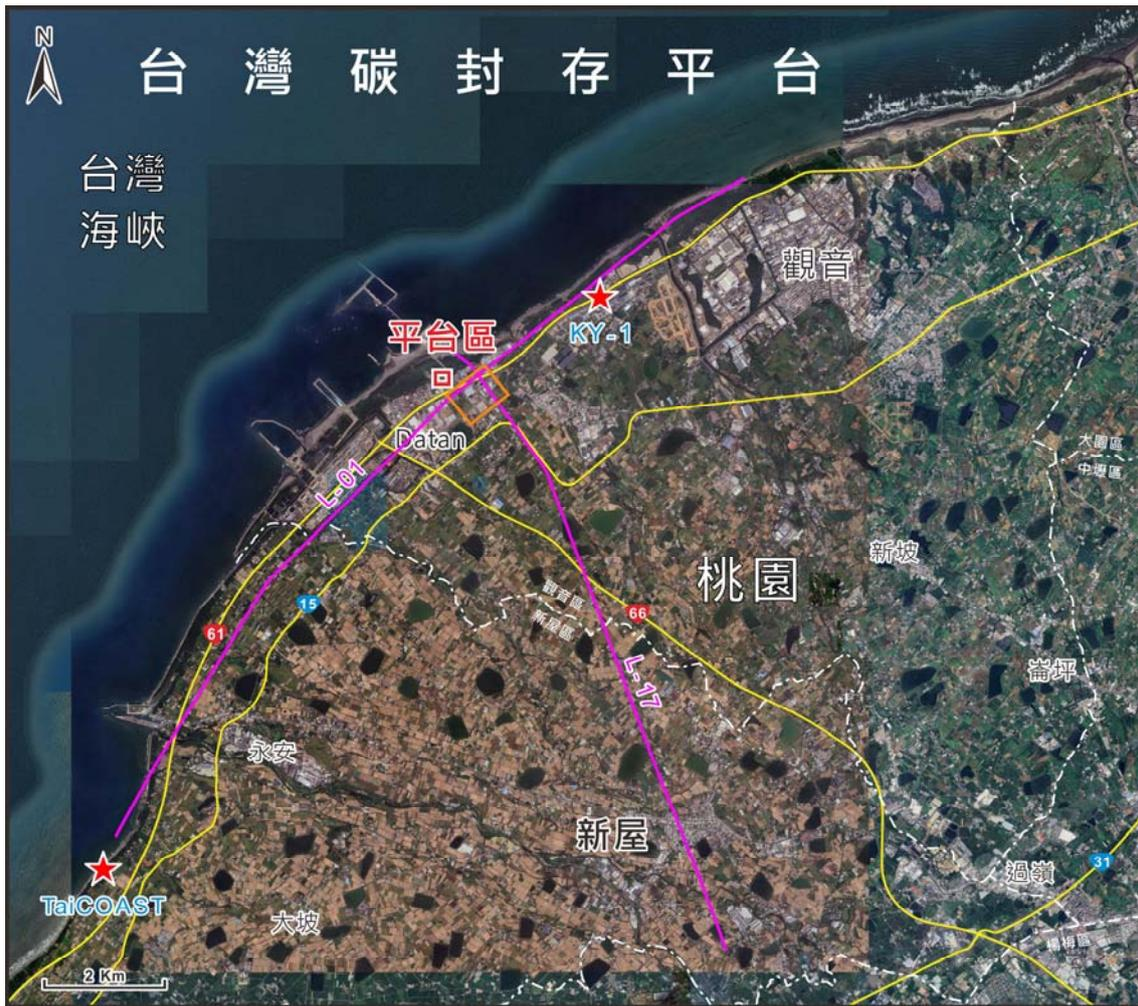
圖 2.3.11 台灣碳封存平台周邊之反射震測及井下資料分布衛星圖，粉紅色線為文獻記載之中油反射震測剖面（L-01 及 L-17）的位置；橘色方框則為科技部前期計畫於桃科園區所蒐集的三維高解析反射震測剖面 TK3D（王乾盈教授團隊提供）；平台區西北方為中油鑽井 KY-1，西南方為最鄰近平台的 TaiCOAST 地下水監測站，可用以建立地下水基線資料。
