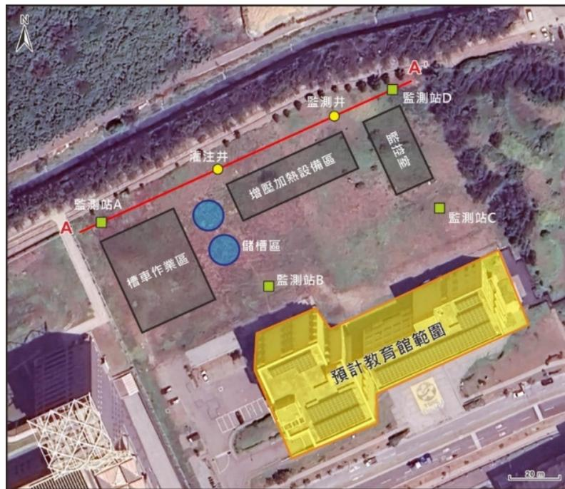
圖 2.3.27 碳封存試驗模場地表設施配置
