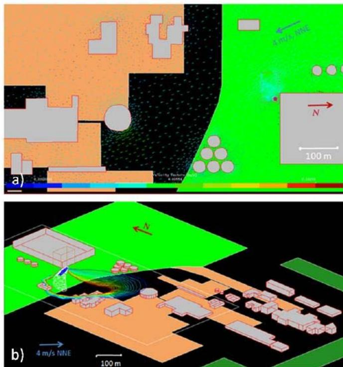
圖 2.4.7 IBDP 的管線末端（井口處）的場區洩漏模擬
